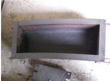
塗布後の型枠
