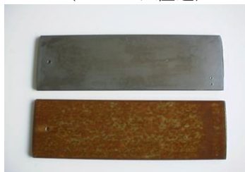
上、防錆剤No31塗布 下、防錆剤処理無し
