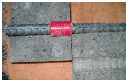
付着応力度測定後の破断面
