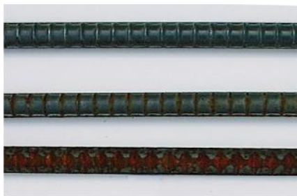
屋外暴露6ヶ月後 (上から) クリアコート #2000、他社品、未処理品
