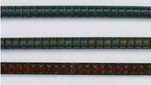
屋外暴露 6 ヶ月後 （上から）クリアコート #2000 他社品 未処理品
