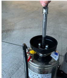
ピストンを上下に動かし 加圧する 40~50回程度
